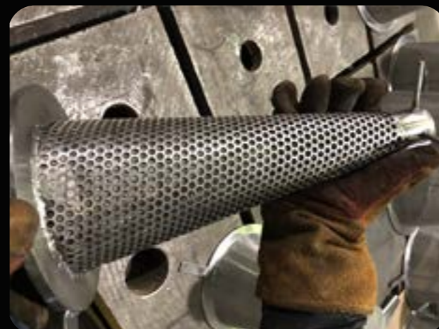
ФИЛЬТРЫ ФСК из нержавеющей криогенной стали по заказу NOVARCTIC Russia для проекта «НОВАТЭК»
