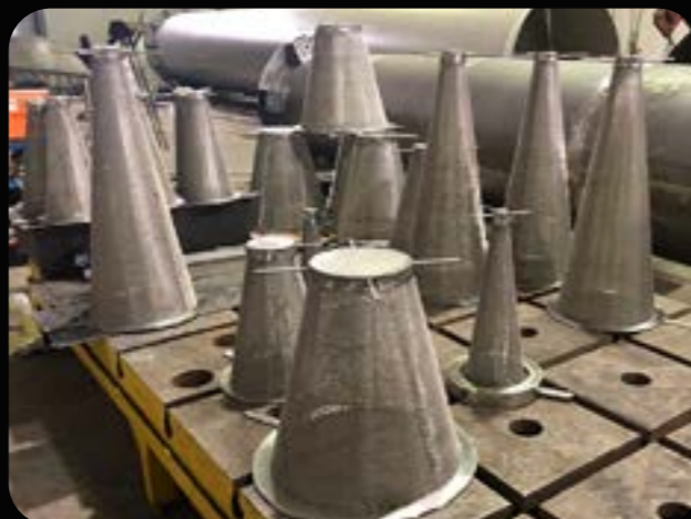
ФИЛЬТРЫ ДЛЯ ОЧИСТКИ ПРИРОДНОГО ГАЗА для проекта «НОВАТЭК» на полуострове Гыдан по разработке месторождения Утреннее
